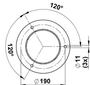
Bohrbild kann gedreht werden!
